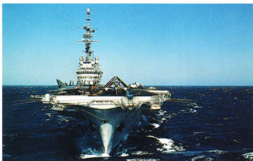
★フランスの海軍の空母「クレマンソー」。全長265メートルで、シュペル・エタンダールなどの艦載機を、44機搭載できるのだ。
